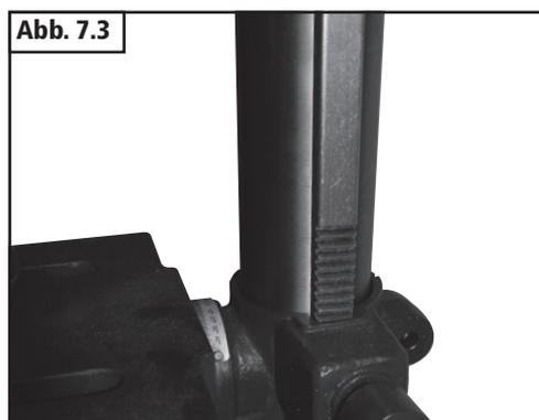
4. Schieben Sie den Tisch und die Zahnstange auf die Säule und vergewissern Sie sich, dass das untere Ende der Zahnstange in die Vertiefung an der Basis der Säule geht (**Abb. 7.4**).
